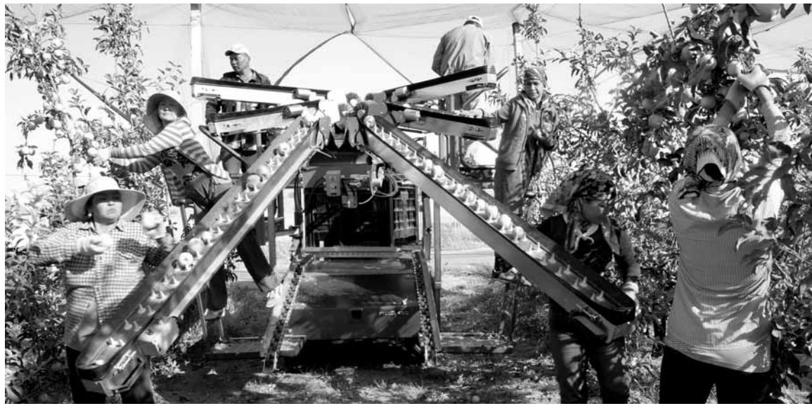
Чудо-машина позволяет в пять раз сократить объем ручного труда при сборе фруктов и увеличить качество хранения яблок. Фото: автора
